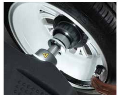
LED leuchtet automatisch bei Einsatz des elektronischen Datenarmes
